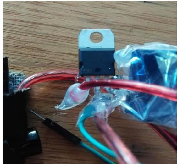
Gambar 11. Transistor IC 7812 berfungsi untuk regulator tegangan dari 16V menjadi 12V
