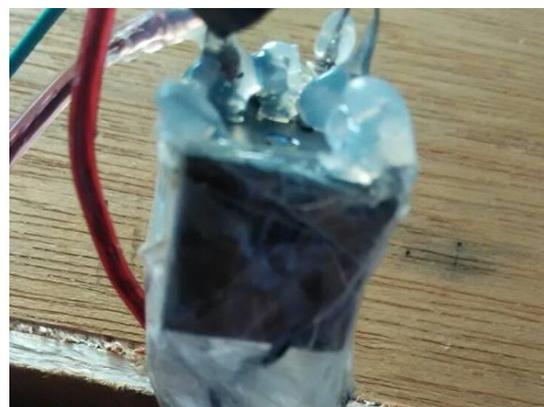
Gambar 13. Relay yang berfungsi sebagai elektromagnetik switch pada pompa air
