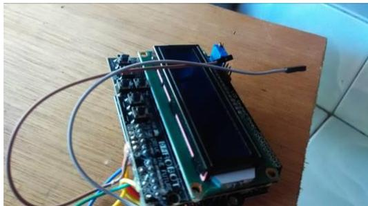
Gambar 16. Kabel pin A5 (abu-abu) dan GND arduino (coklat)
