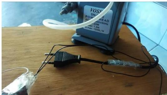
Gambar 17. Rangkaian dari relay pin 85, resistor 10 ohm, dioda, saklar pompa air
