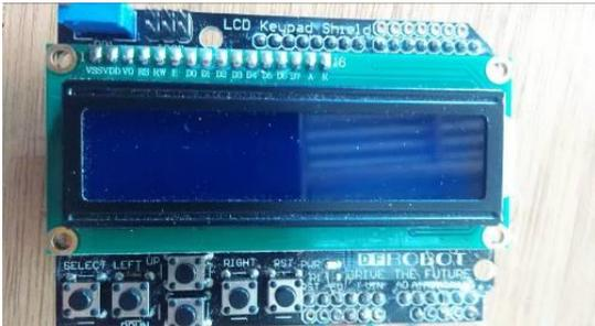
Gambar 8. LCD shield with button yang berfungsi untuk mengetahui parameter suhu
